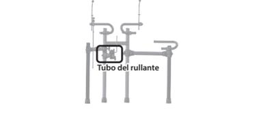
3-1. Usate la chiave per tamburi per allentare il bullone del supporto C, e inserite il tubo del rullante (9) nel supporto C del telaio centrale (5).
