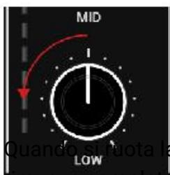
Quando si ruota la manopola **EQ** completamente in senso antiorario, si rimuove completamente la singola banda di frequenza dal segnale audio.
