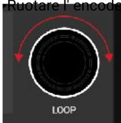
La dimensione del loop per il loop attivato cambia istantaneamente in base alla rotazione della barra di controllo del loop.
