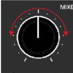
Se è selezionato **FILTER** , ruotando la manopola **MIXER FX** Amount si applica solo un filtro passa basso o un filtro passa alto al segnale audio.
