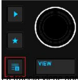
La traccia viene aggiunta all'elenco di preparazione. Un'icona a forma di diamante appare nella prima colonna dell'Elenco tracce in TRAKTOR indicando che la traccia è stata aggiunta all'Elenco preparazione. Premendo nuovamente il pulsante Elenco di preparazione si rimuove la traccia dall'elenco di preparazione.
