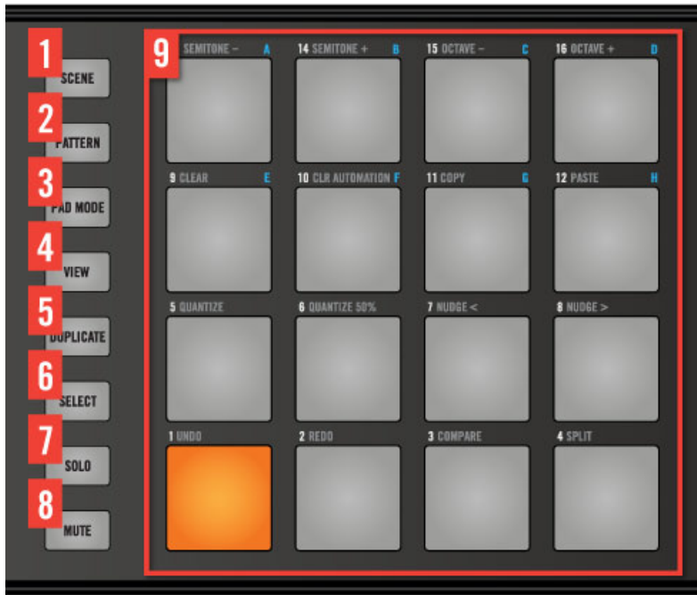
Panoramica della sezione PAD
