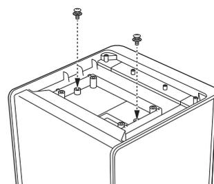
**6** Riposizionare il coperchio del vano batterie e fissarlo saldamente con le quattro viti.
