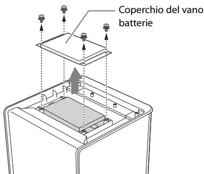
**4** Rimuovere le due viti che fissano la batteria, quindi staccare la batteria.
