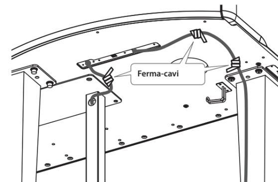
5. Collegate il trasformatore e il cavo di alimentazione forniti, e collegate il cavo di alimentazione a una presa di corrente.
