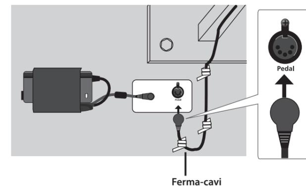
4. Inserite il cavo di alimentazione incluso nel trasformatore di CA, e usate un ferma-cavo per fissarlo (una posizione).
