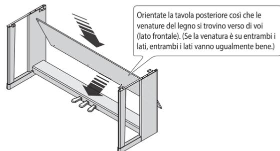
4. Usate le viti **7** per fissare la tavola posteriore **5** dal lato anteriore alle staffe metalliche all'interno delle tavole laterali. Poi usate le viti **8** per fissare la tavola posteriore alla pedaliera **6** da dietro.
