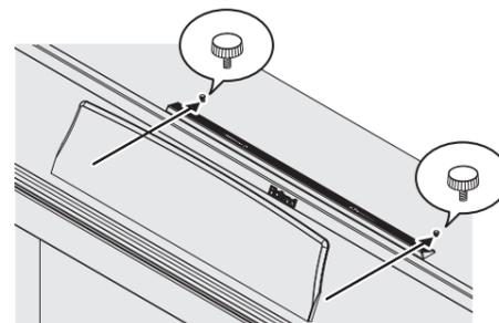
Quando montate il leggio, controllate che sia completamente inserito verso il retro, e usate la mano per sostenere il leggio così che non cada. State attenti a non pizzicarvi la mano.
