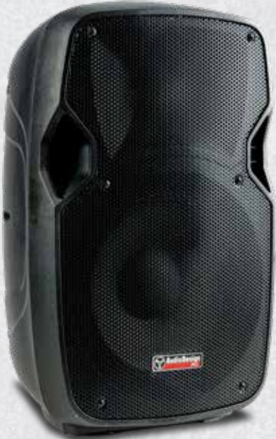
M.10USB Diffusore attivo professionale a 2 vie Woofer: 10"/250 mm - Driver V/C: 25 mm Max Power: 360 W SPL max: 112 dB 1 m Peso Kg 12 - Dimensioni: 33x28x49 cm
