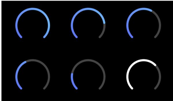
3. Parla o canta nel microfono oppure suona il tuo strumento durante il conto alla rovescia del Gain Automatico. Suona come faresti durante la registrazione per accertarti che il Gain Automatico imposti un buon livello.
