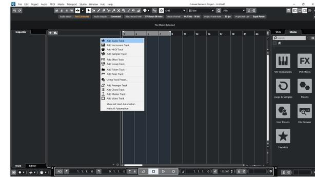
8. Configura il tipo di traccia come Audio e imposta **Ingresso Audio** sul canale che stai utilizzando sulla tua interfaccia.
